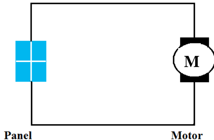
Obr. 16: Nejjednodušší způsob zapojení fotovoltaického panelu
