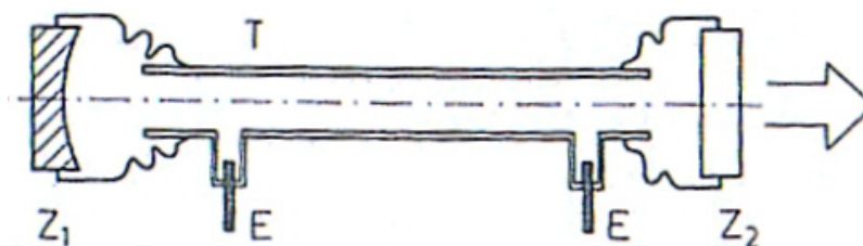
Obr. 22 Schéma CO 2 laseru [10]
