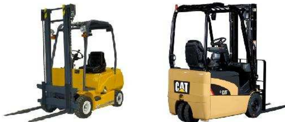
Obrázek 11 – Vysokozdvížený vozík DESTA [31], CATERPILAR [22]
