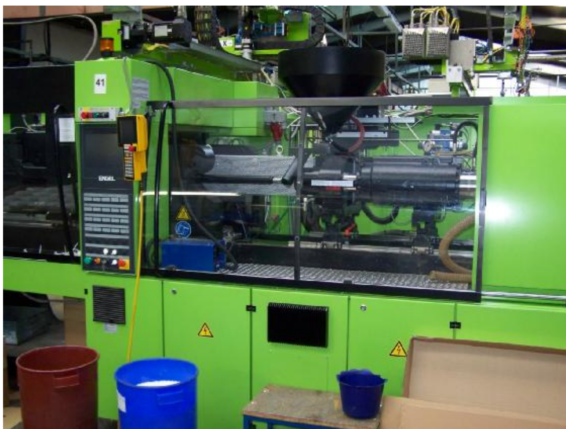
Obr. 14. Vstřikovací stroj ENGEL řady VICTORY 750 / 220 TECH, POWER
