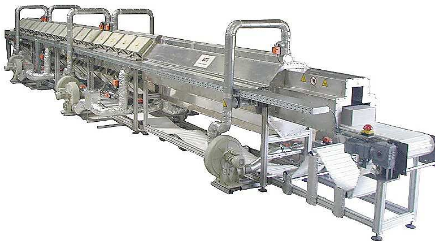
Obr. 22. Mikrovlnná pásová sušička s výkonem 64kW pro vysoušení keramiky.
