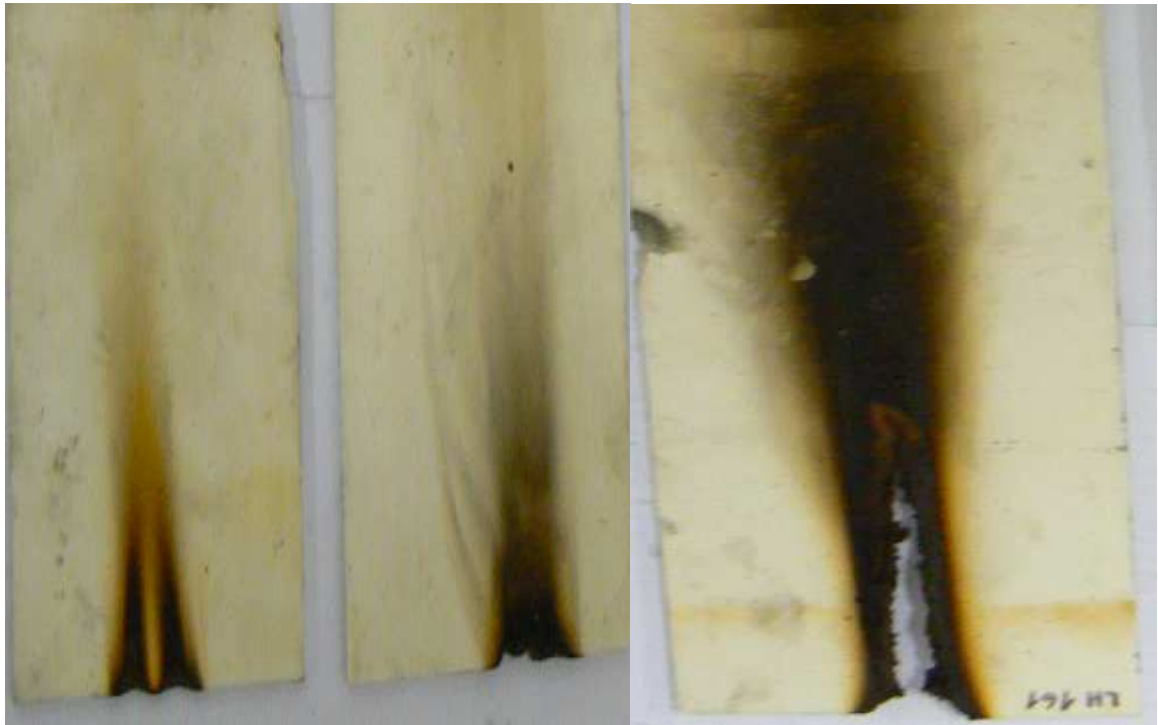
Obr. 23 Vzorky po zkoušce hořlavosti
