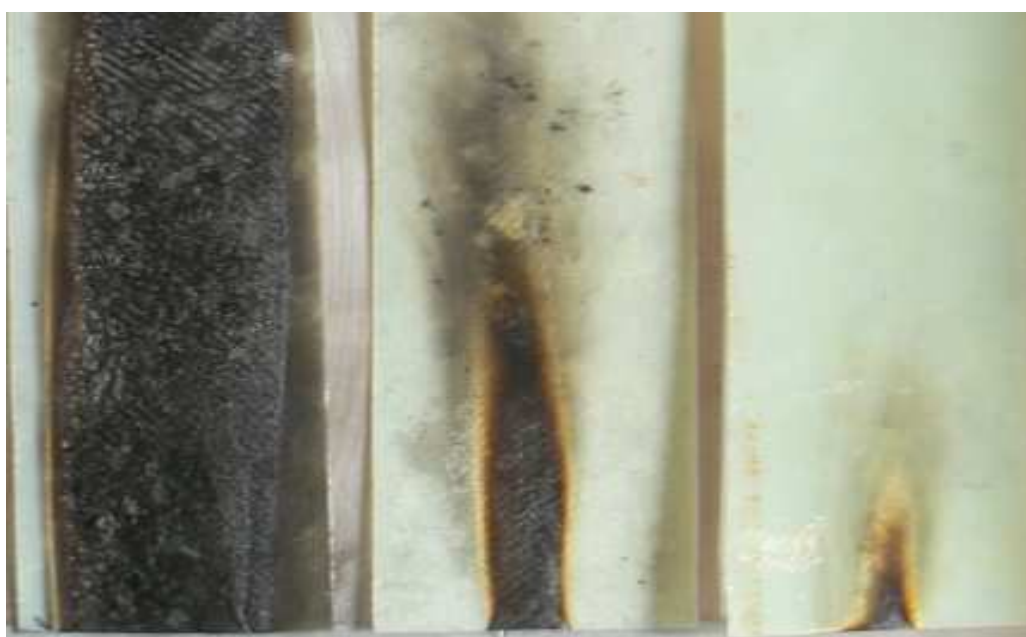
Obr. 21 Vzorky po zkoušce hořlavosti
