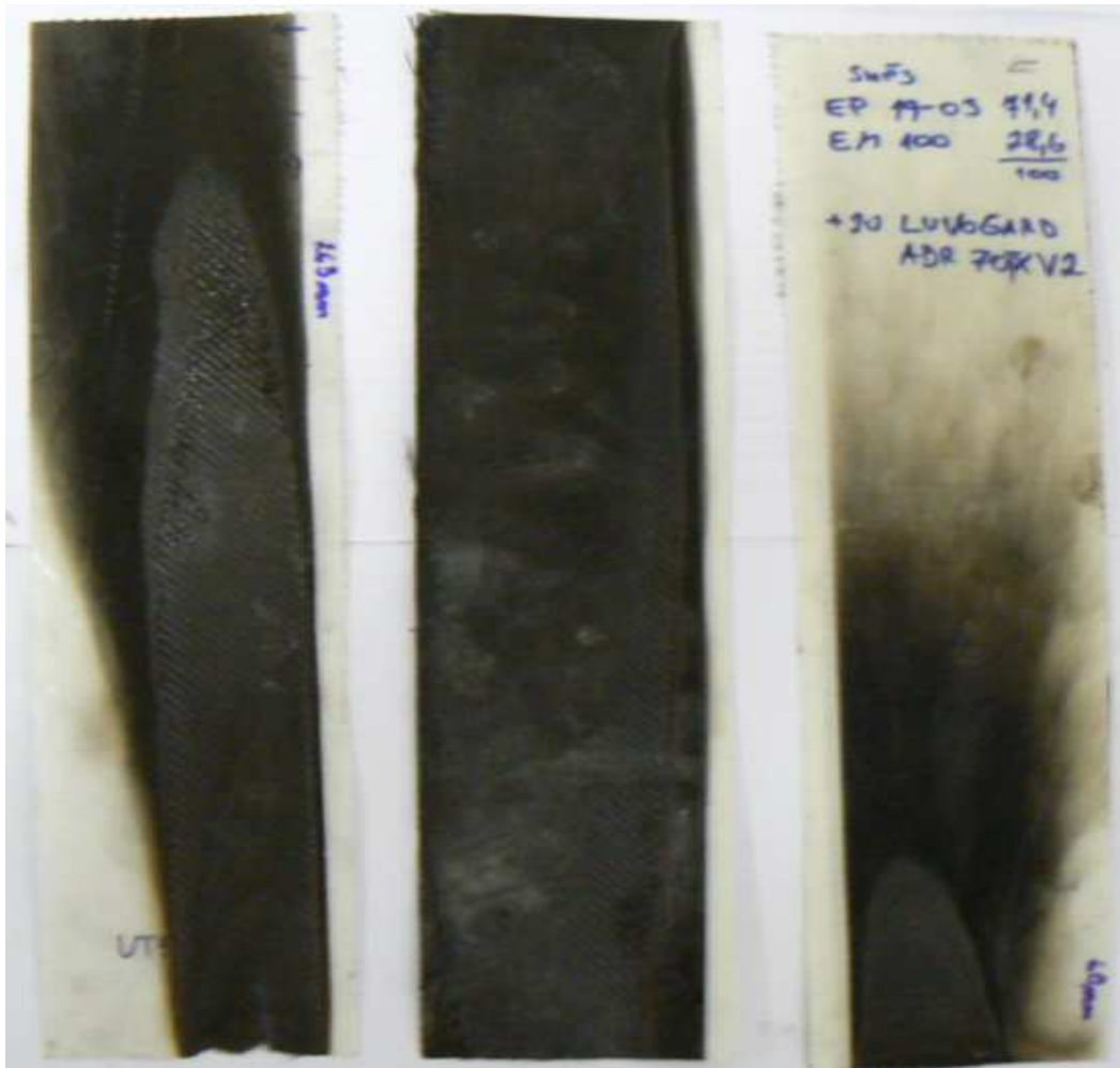
Obr. 22 Vzorky po zkoušce hořlavosti
