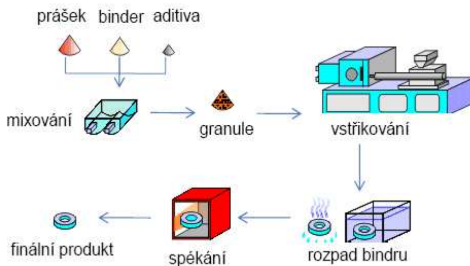
Obrázek 8 Schéma průběhu PIM technologie [20]
