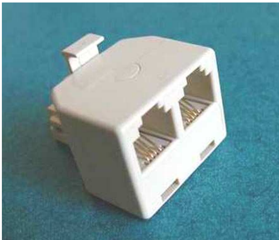
Obr. 11 Radiovysílač ukrytý v telefonní rozdvojce s dosahem až 200m [5]
