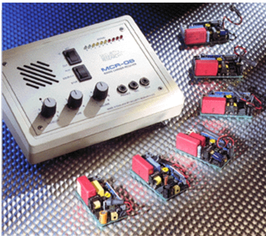
Obr. 4 Souprava pro odposlech využívající vedení 230V jako přenosové cesty [5]
