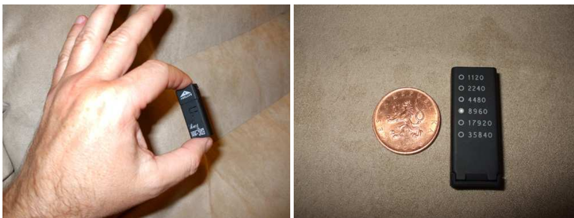
Obr. 2 Malé digitální odposlechové zařízení - hlasový záznamník EDIC MINI B21 [11]
