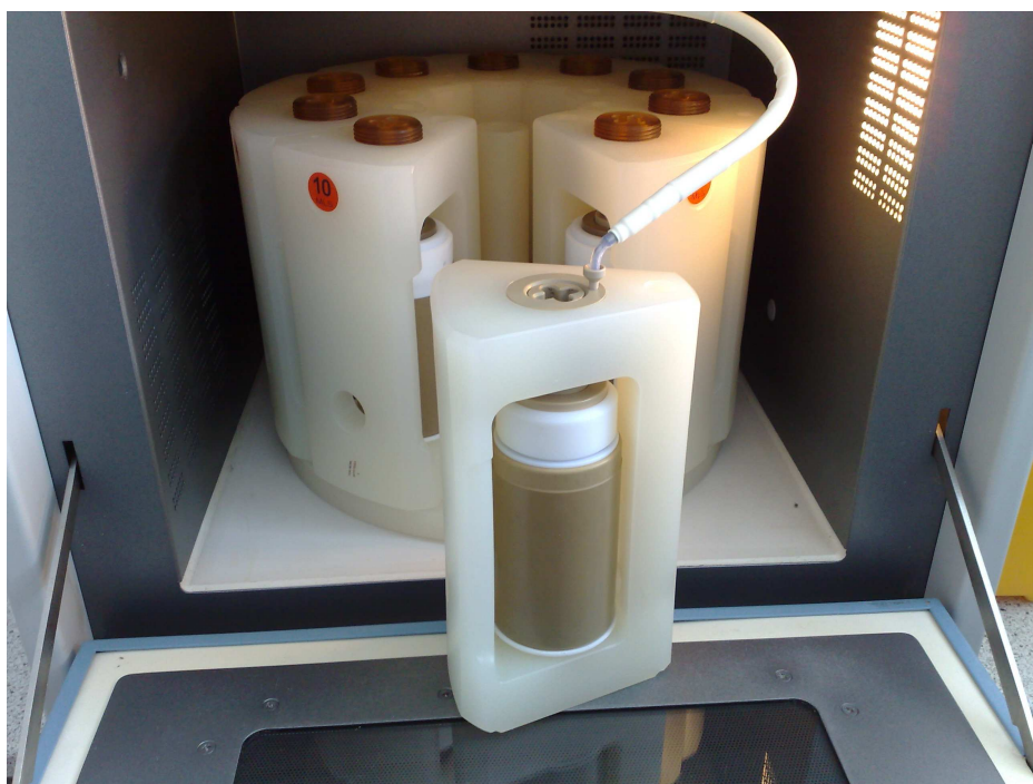
Obr.4. Rotor mikrovlnné pece se vzorky v uzavřených teflonových nádobkách
