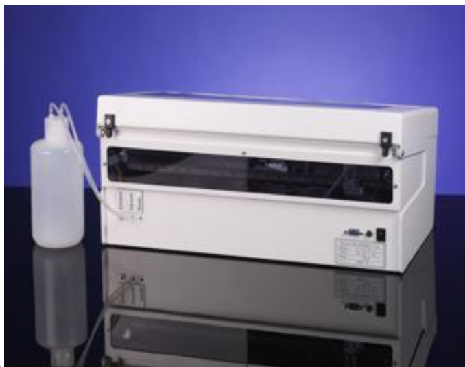
Obr. 26 – Zadní část přístroje Dynablot, připojení odpadní nádoby
