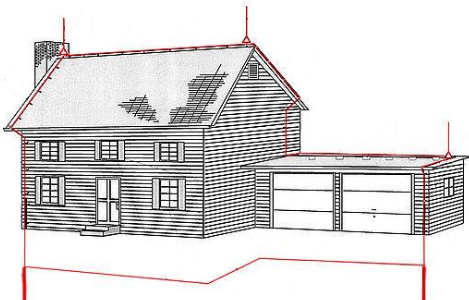
Obrázek 10. Ochrana budovy pasivními hromosvody
