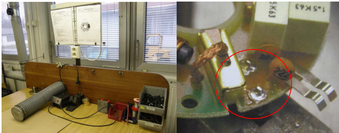
Obr. 26 Offline pracovisko - ručné spájkovanie priechodky [vlastné]
