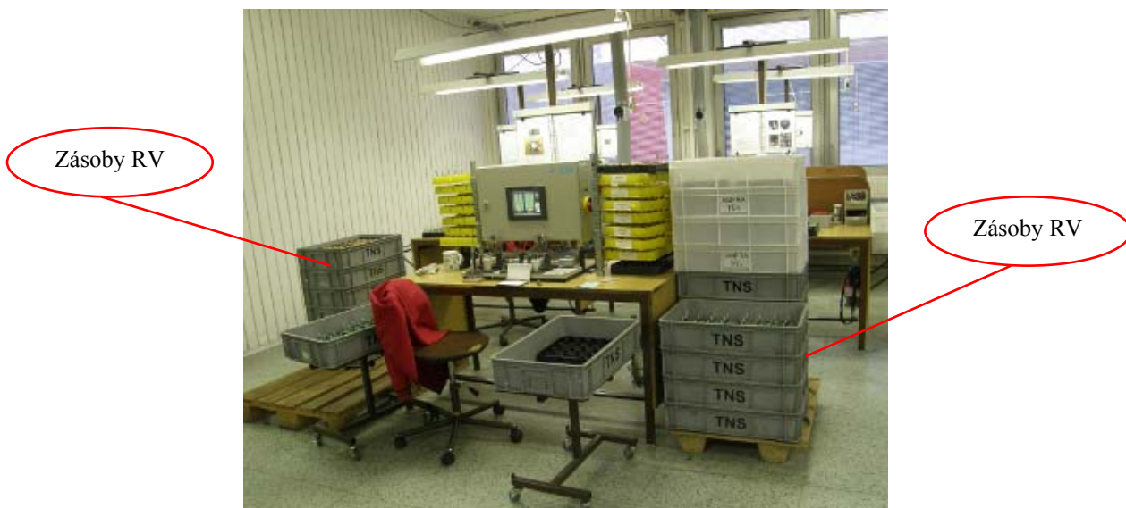
Obr. 27 Pracovisko elektrickej skúšky [vlastné]
