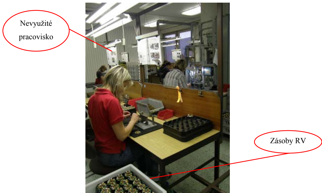
Obr. 25 Montáž krúžku a pružiny ručná [vlastné]
