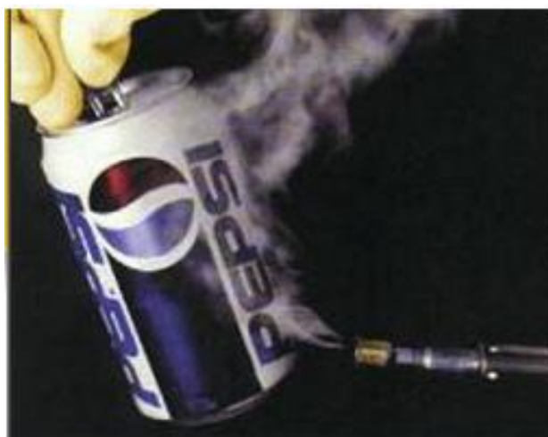
Obr. 14. Kyanová hůlka - ruční vyvíječ kyanoakrylátových par. [2]
