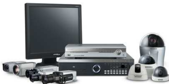
Obr. 12 Jednotlivé části CCTV systému [25]
