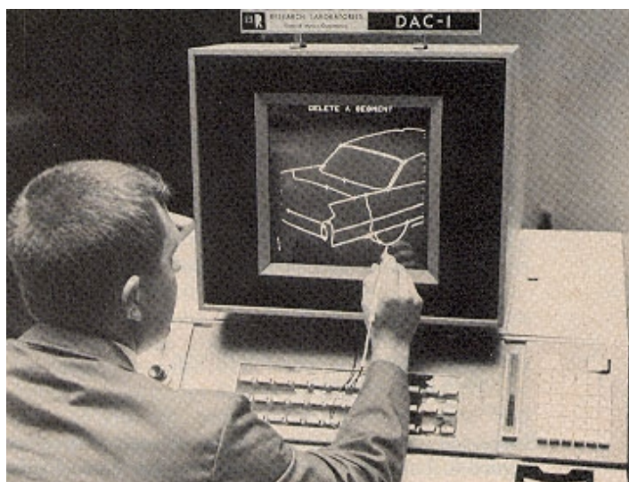
Obrázek 3. DAC – Design automated by komputer – první CAD/CAM systém [3]
