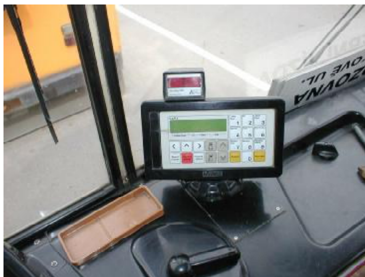
Obr. 2 - Pohled na dnes již takřka historický osmibitový PP PSQ-02A výrobce SAVS Olomouc s namontovaným zařízením Starling výrobce ART Brno
