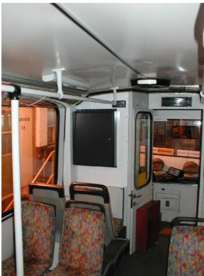
Obr. 14 – pohled na základní skříň informačního systému ve voze Tr15
