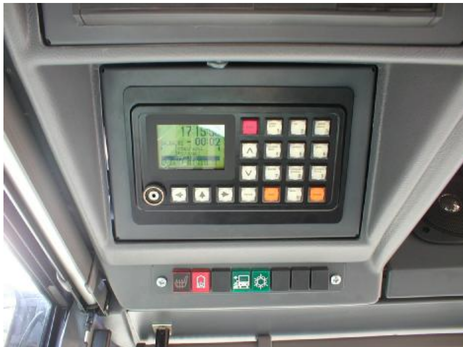
Obr. 6 - detail umístění terminálu ve voze Karosa renault CityBus
