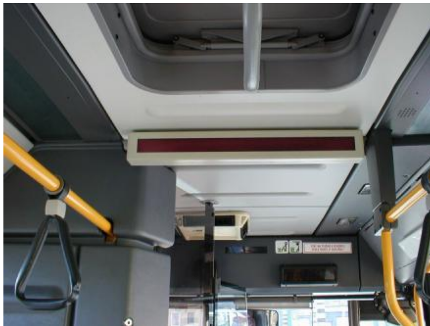
Obr. 8 - detail umístění vnitřního informačního panelu
