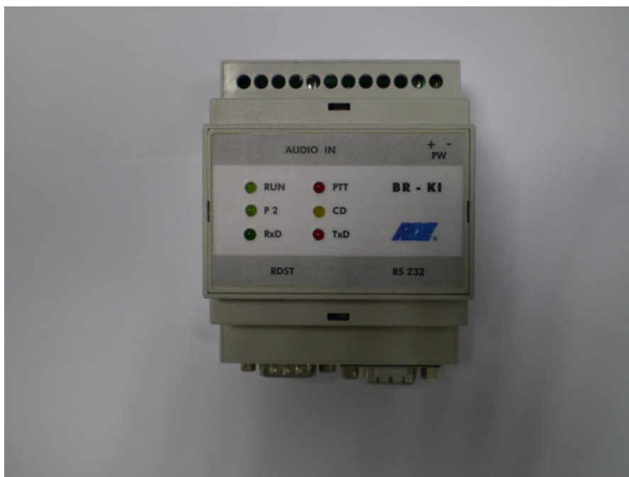
Obrázek 14 Komunikační interface bezdrátového rozhlasu
