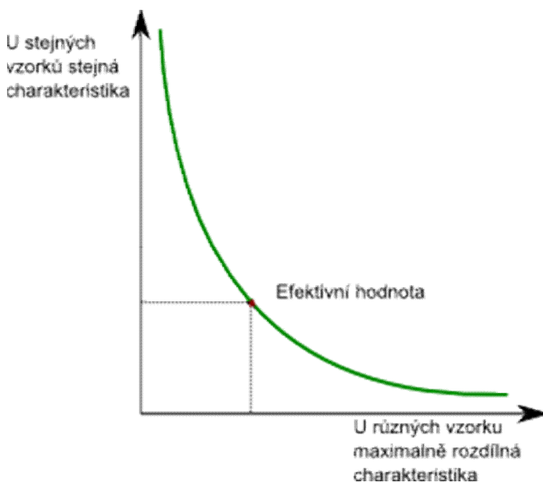
Obrázek 27 Grafické vyjádření efektivní hodnoty.
