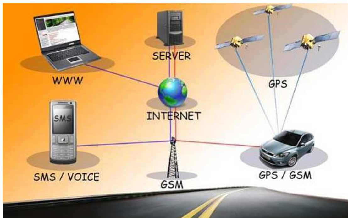
Obr.3. Elektronická kniha jízd – schéma komunikace. [7]
