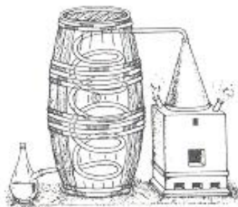
Obr. 1. Destilační přístroj z 16. století.
