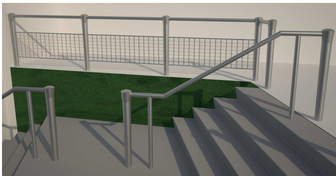
Obr. 85. Detail zábradlí s mřížkou výplně.
