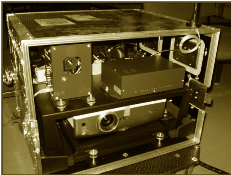
Obrázek 15. V kufře uložený projektor se snímací kamerou a dalším HW
