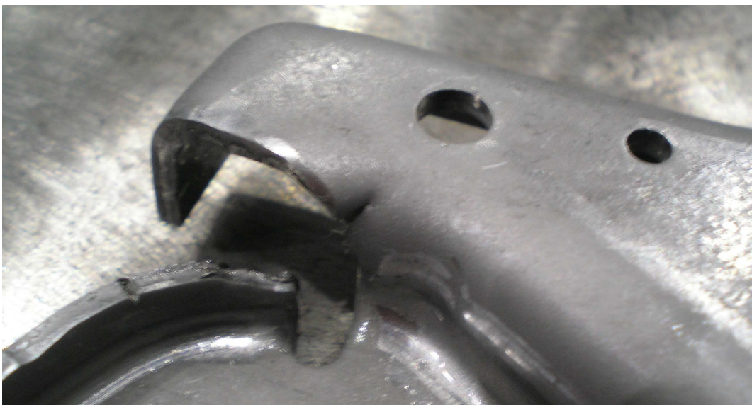
obr. 40 Natržení dílu po odlisování
