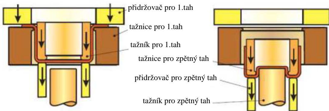
obr. 7 Zpětné tažení
