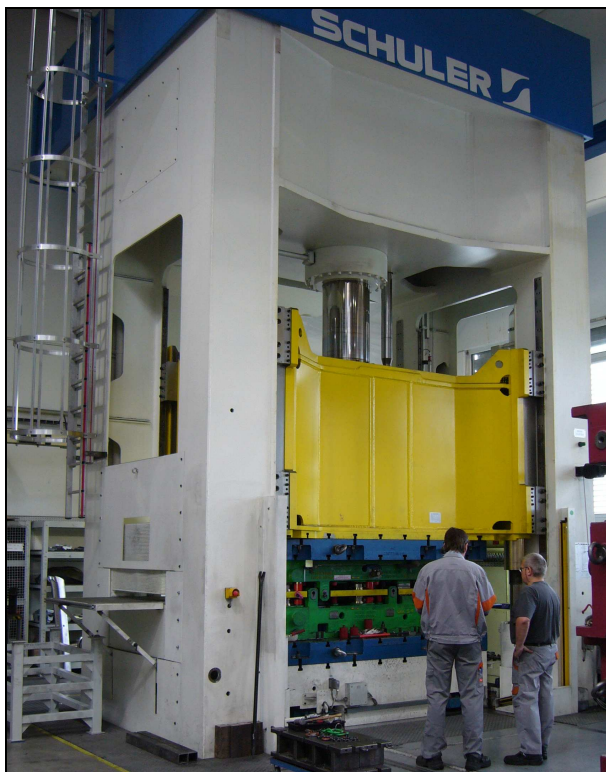
obr. 19 Zkušební 600 tunový hydraulický lis
