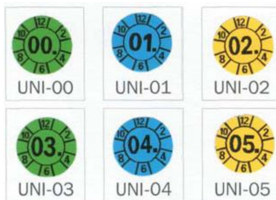
Obr. 3. Příklad kalibračních značek
