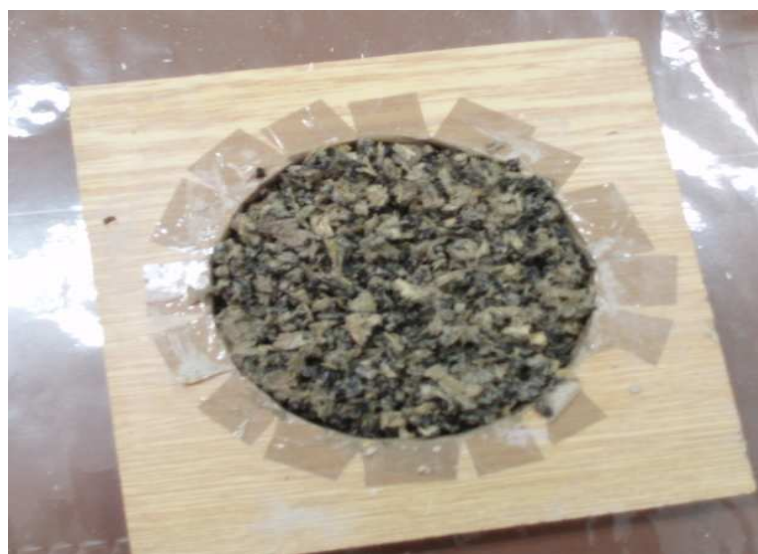
Obr. 19. Forma piliny – gum. drť
