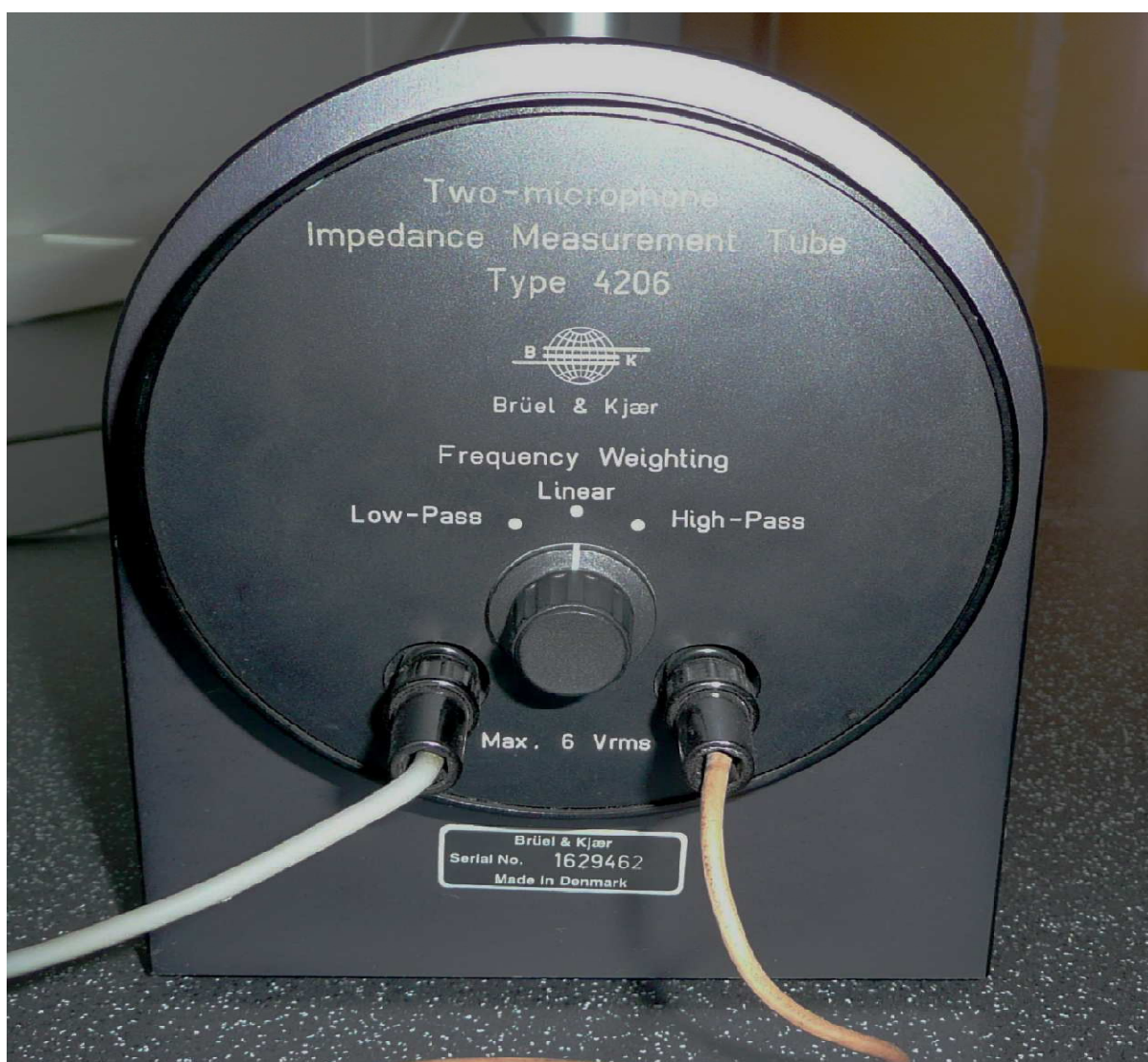
Obr.10. Bočný pohľad na Kundtovú impedančnú trubicu
