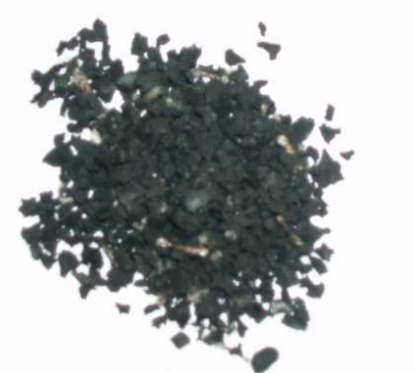
Obr. 13. Vzorka gumárenskej drte
