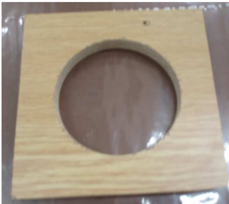
Obr. 16. Forma o priemere 98 mm
