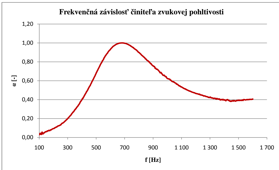
Obr. 28. Piliny – cement so vzduchovou medzerou 2 cm
