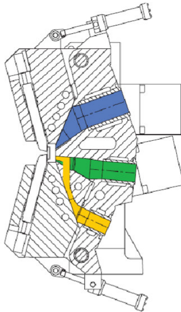
Obr. 6. Vytlačovací hlava pro vytlačování koextruzních profilů. [10]
