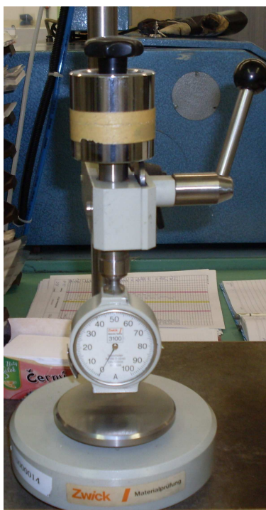
Obr. 22. Stolní tvrdoměr Zwick 3100 určený pro stanovení tvrdosti Shore A
