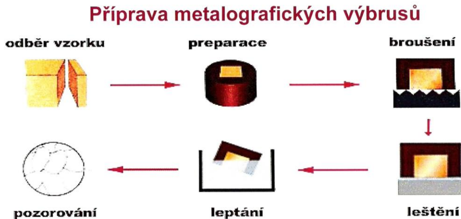
Obr. 6.: Schéma průběhu metalografického výbrusu
