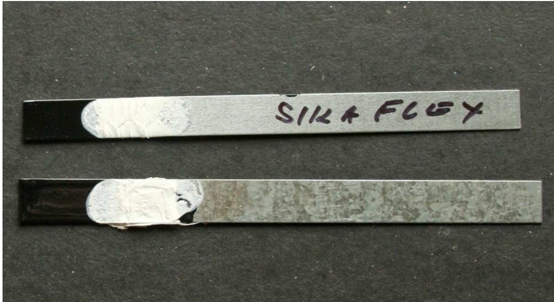
Obr. 22 Roztržený vzorek spoje – Sikaflex 252
