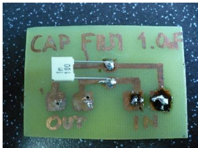
Obrázek 29: DPS nesoucí filmový kondenzátor
