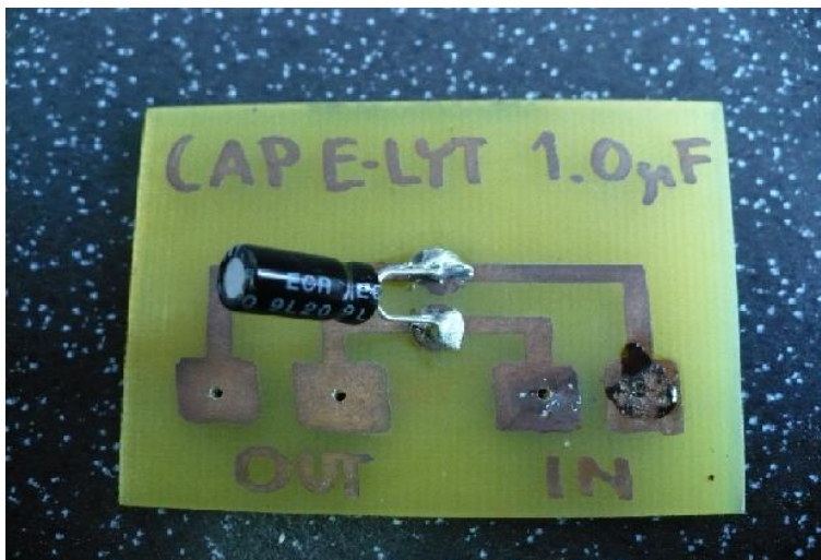
Obrázek 24: DPN nesoucí elektrolytický kondenzátor 1.0 \mu F
