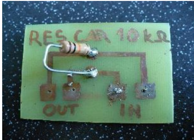
Obrázek 34: DPS nesoucí uhlíkový rezistor
