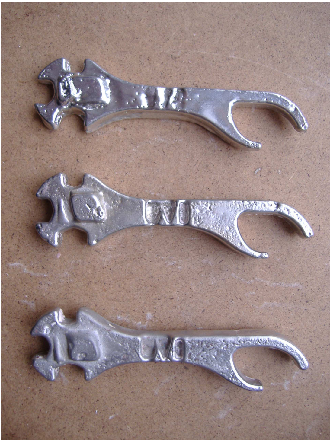
obr. 43. Odlitky odlité do forem odshora ad1, ad2, ad3
