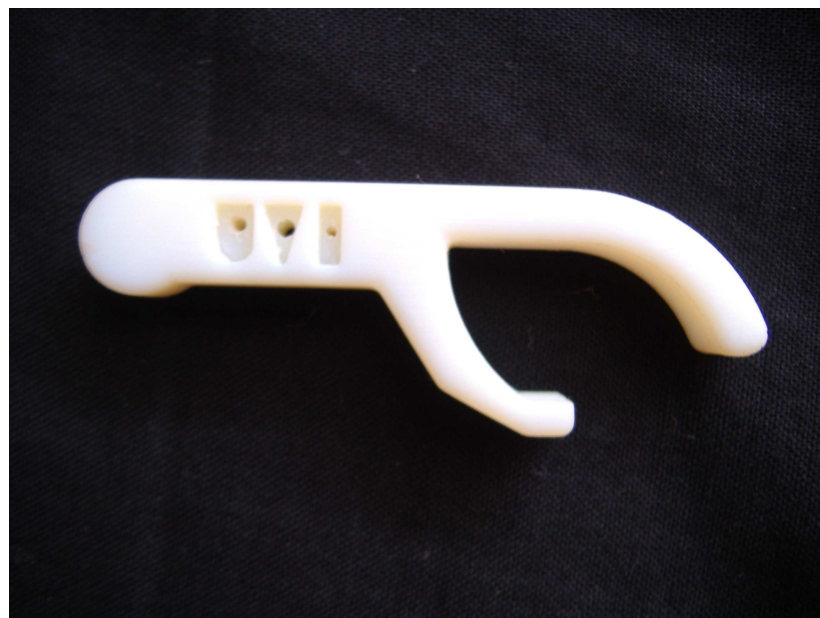
obr. 29. Očištěný slévárenský model otvíráku (zde již s odvětráním)
