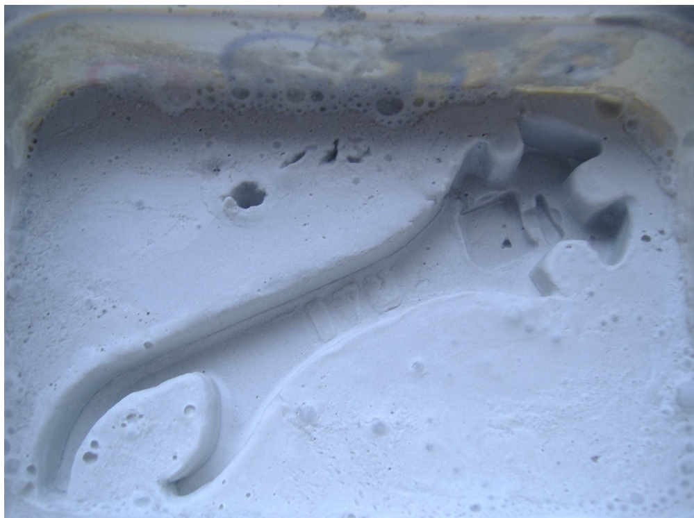
obr. 32. Sádrová forma pro klíč s otvírákem
