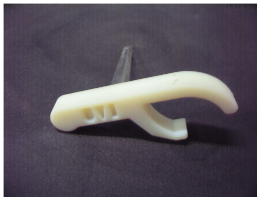
obr. 30. Slévárenský model s nalepeným kuželem
