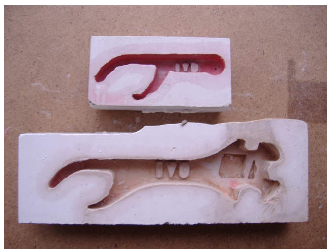
obr. 37. Formy vzniklé vypálením voskového modelu
