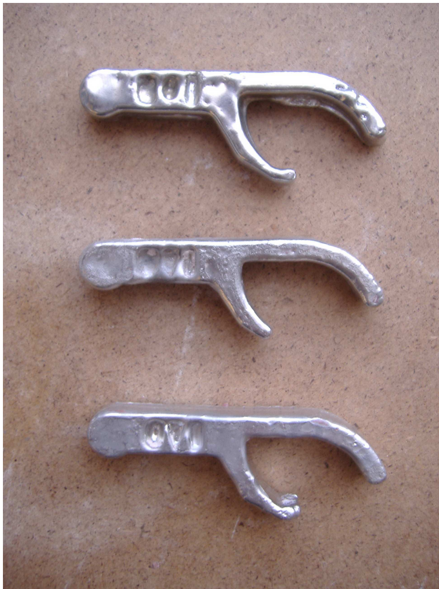
obr. 42. Odlitky odlité do forem odshora ad1, ad2, ad3
