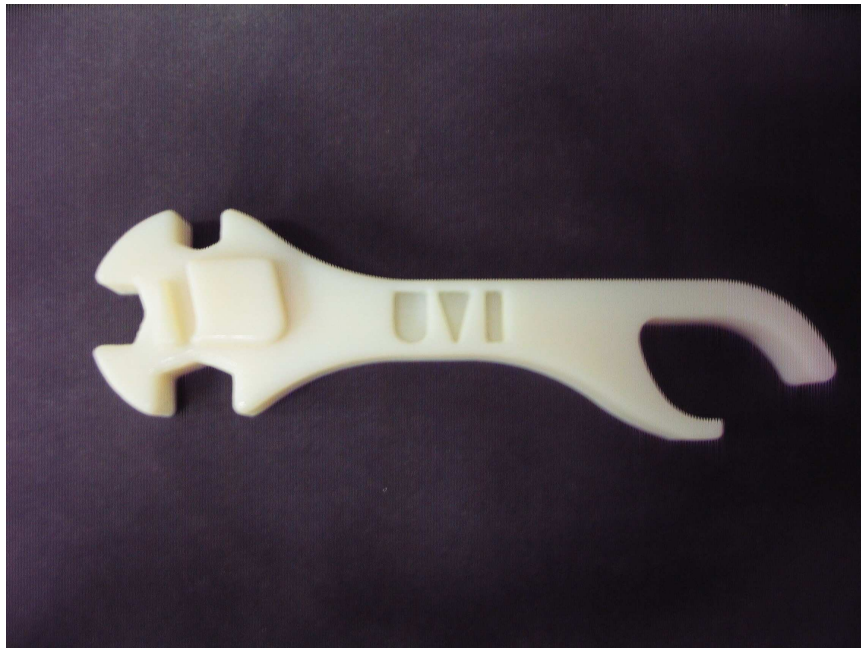
obr. 28. Očištěný slévárenský model klíče s otvírákem
