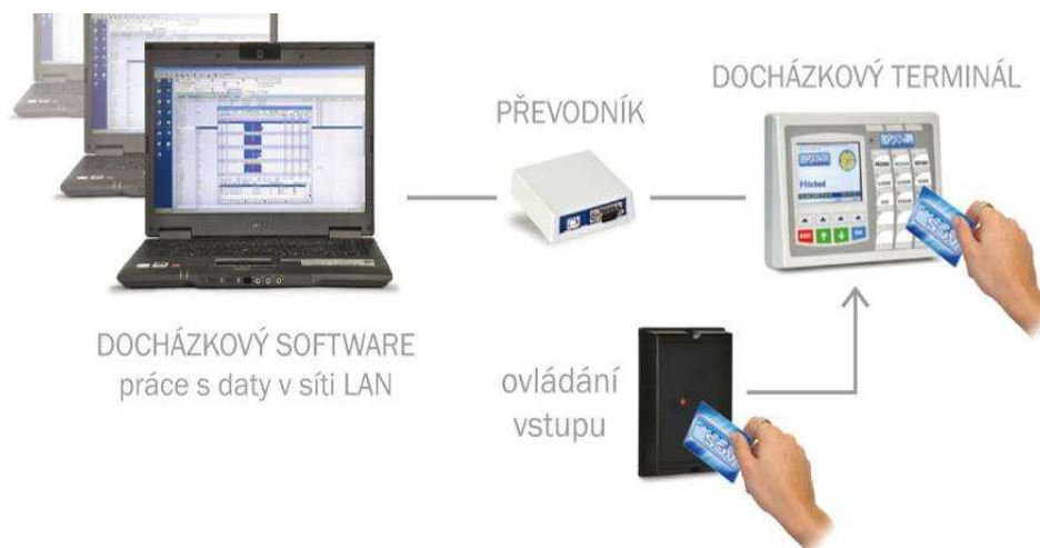
Obr. č. 23 Schéma principu docházkového systému
