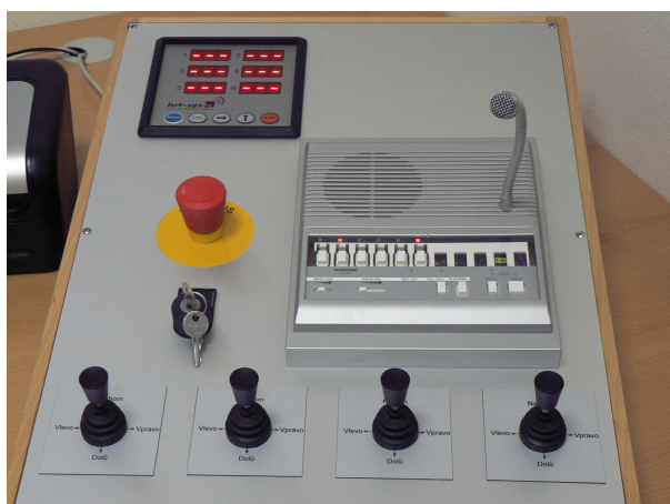
Obr. 22. ovládací panel interkomu a systému kamer
