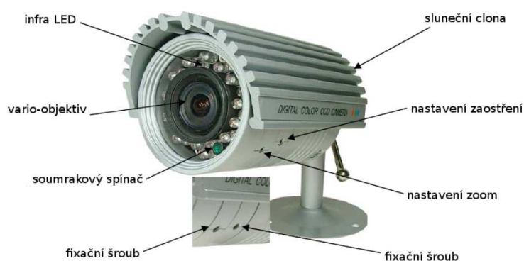
Obr. 15. popis kamery s IR přisvícením
