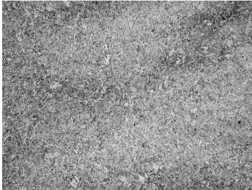
Obrázek 47: Náprava 58009/4 (187) – Podélný řez – Struktura 5 mm pod povrchem. Leptáno – Nital 100 x. [12]
