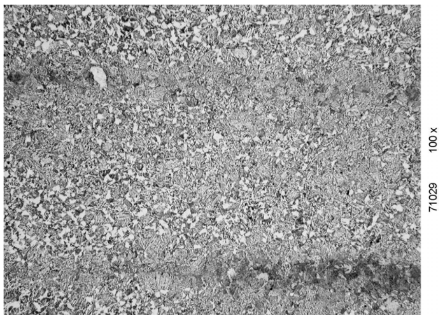
Obrázek 43: Náprava 58009/3 (186) – Podélný řez – Polovina poloměru nápravy. Leptáno – Nital 100 x. [12]
