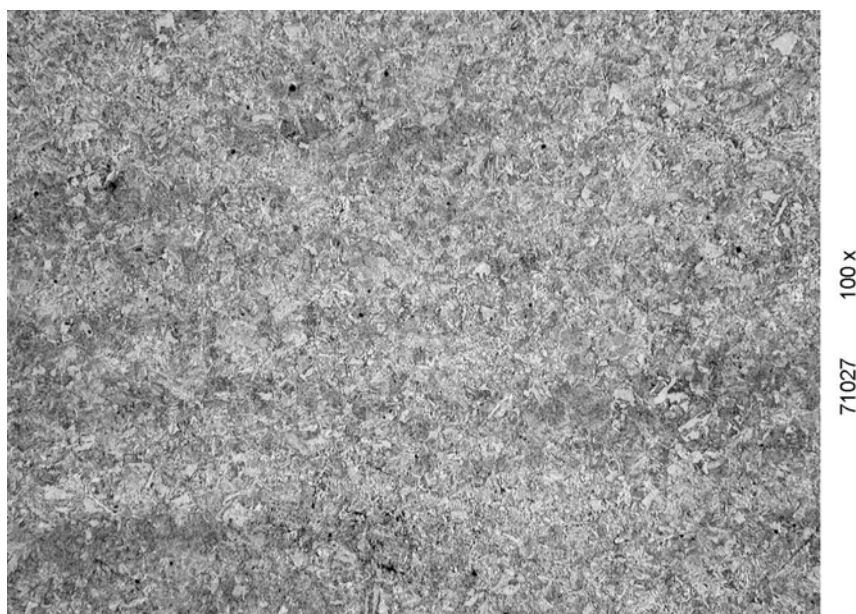
Obrázek 41: Náprava 58009/3 (186) – Podélný řez – Struktura 5 mm pod povrchem. Leptáno – Nital 100 x. [12]
