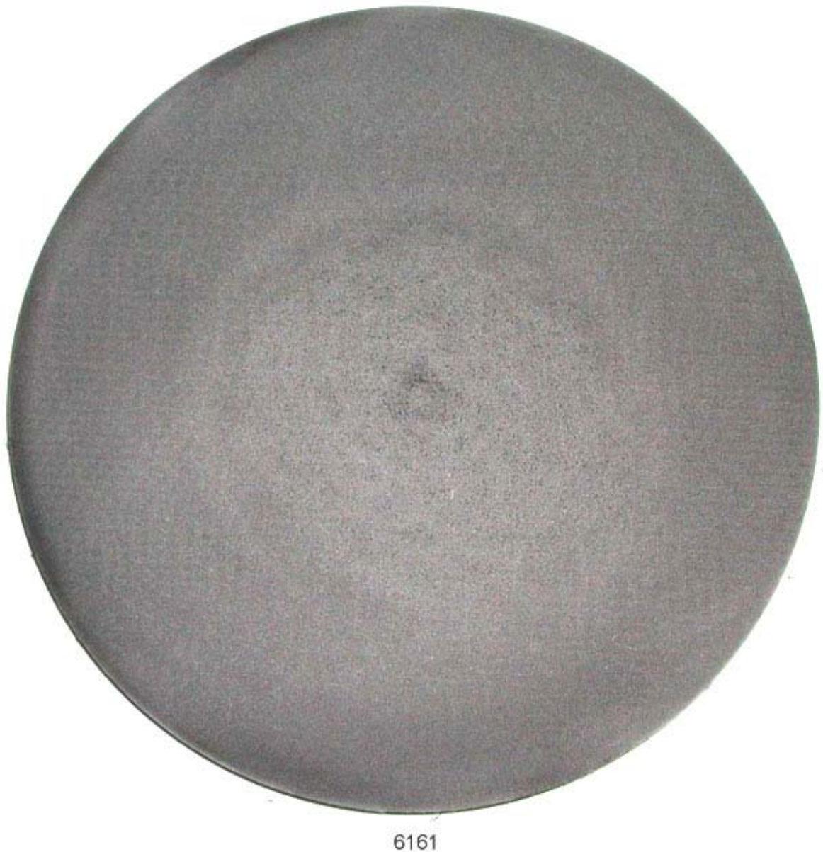
Obrázek 28: Výsledek makroleptu 10% HNO_3 pro nápravu č. 187. [12]
