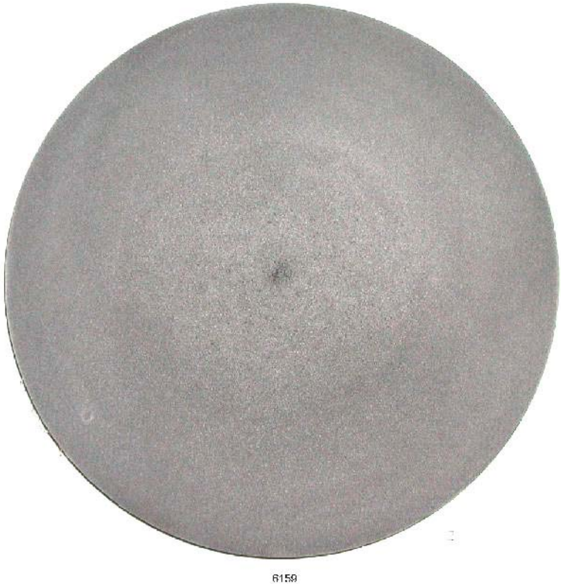
Obrázek 26: Výsledek makroleptu 10% HNO_3 pro nápravu č. 185. [12]
