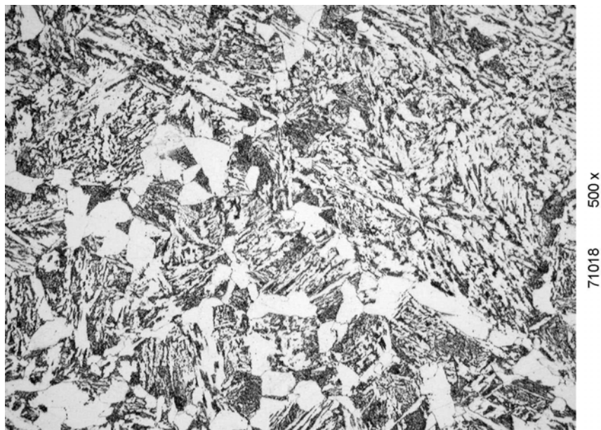
Obrázek 32: Náprava 58009/1 (184) – Podélný řez – Polovina poloměru nápravy. Leptáno – Nital 500x. [12]
