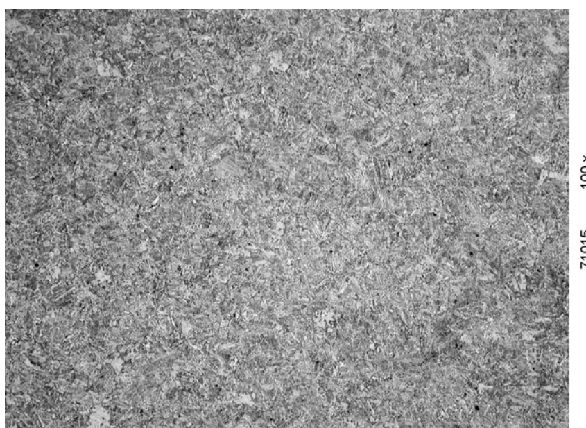
Obrázek 29: Náprava 58009/1 (184) – Podélný řez – Struktura 5 mm pod povrchem. Leptáno – Nital 100 x. [12]
