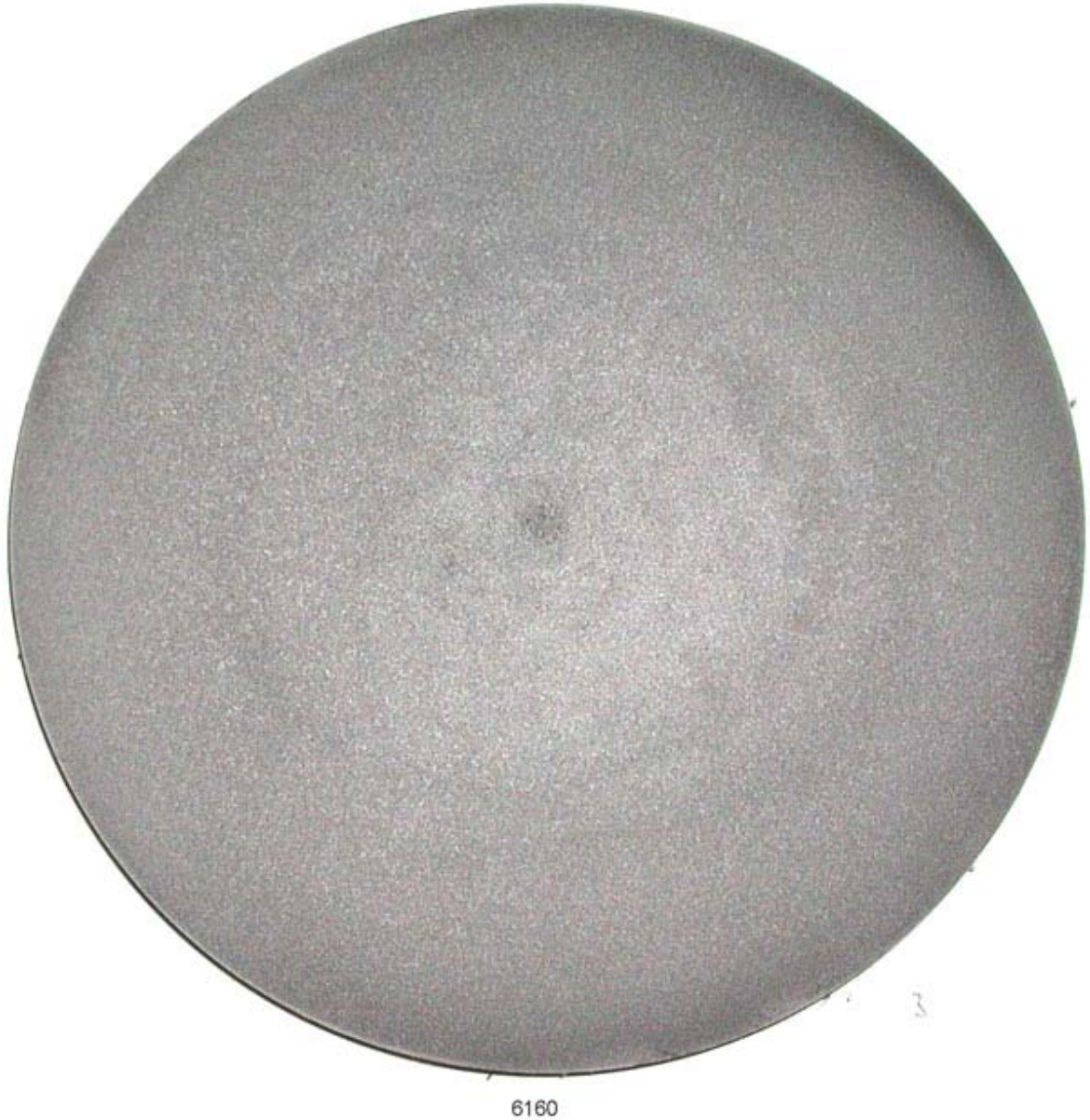
Obrázek 27: Výsledek makroleptu 10% HNO_3 pro nápravu č. 186. [12]
