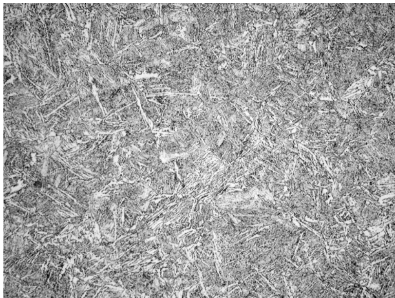
Obrázek 36: Náprava 58009/2 (185) – Podélný řez – Struktura 5 mm pod povrchem. Leptáno – Nital 500 x. [12]
