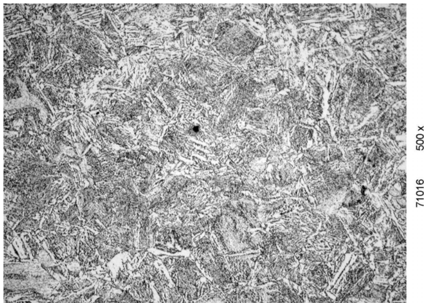
Obrázek 30: Náprava 58009/1 (184) – Podélný řez – Struktura 5 mm pod povrchem. Leptáno – Nital 500 x. [12]
