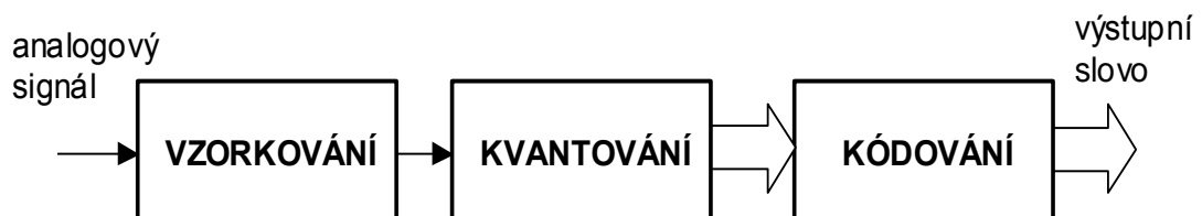
Obr. 9 Funkční schéma A/D převodníku [3]
