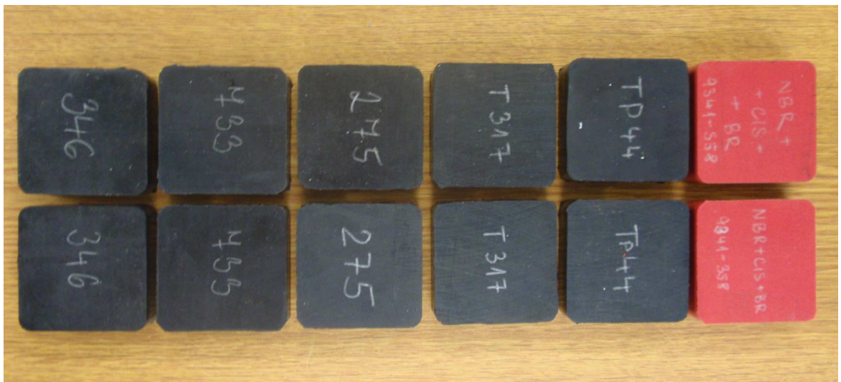
Obr. 44 Vylisované zkušební vzorky
