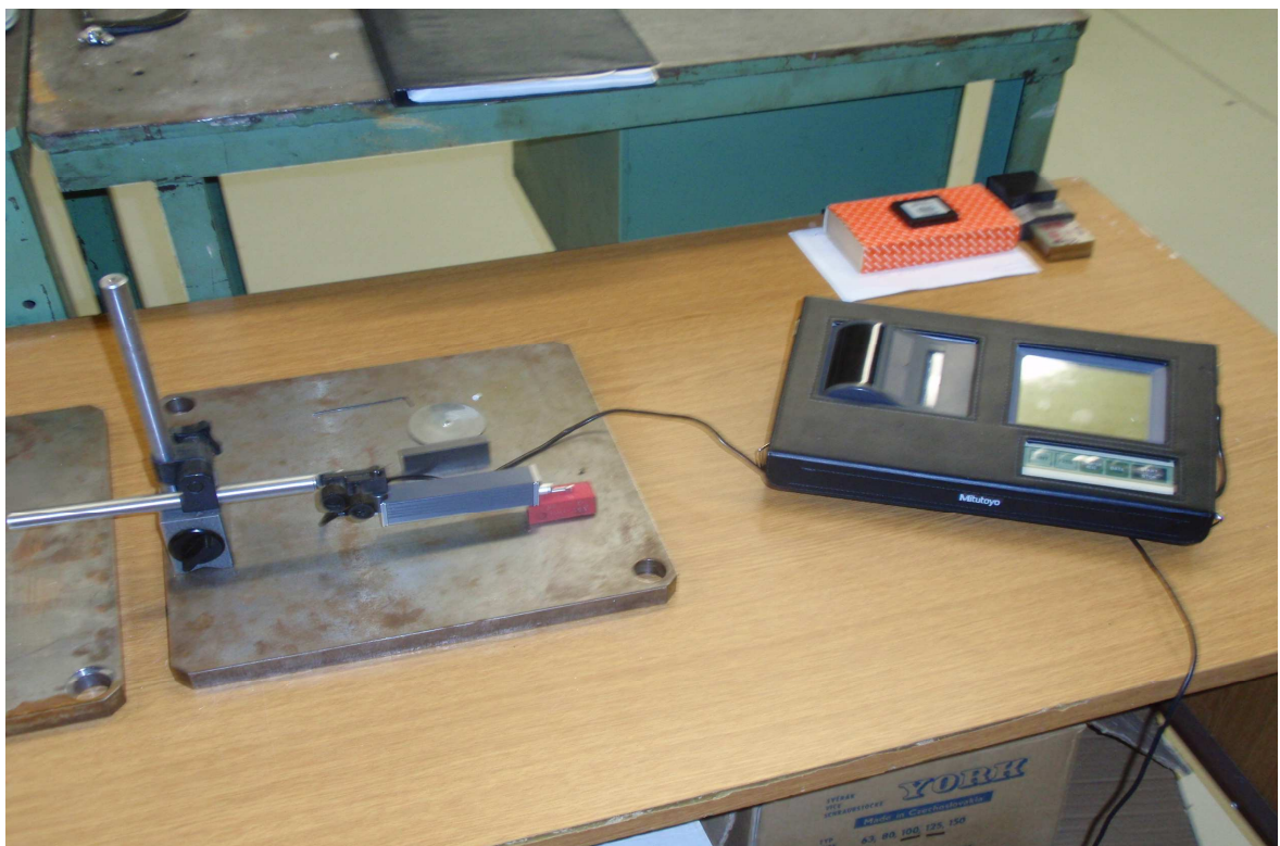
Obr. 49 Drsnoměr Mitutoyo SJ - 301
