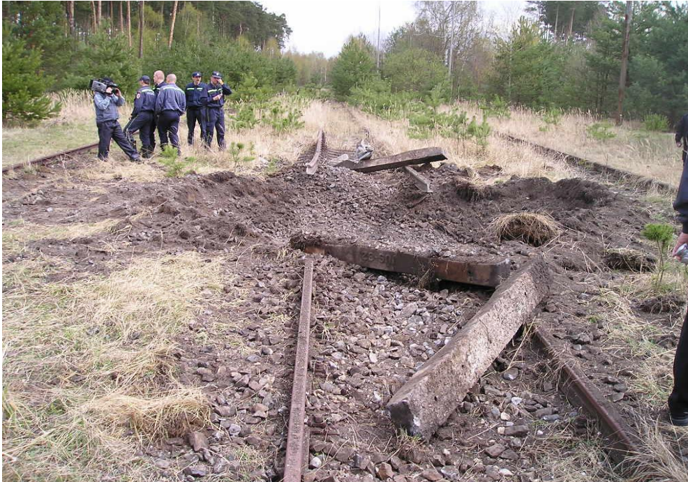
Obr. . 8 Dokumentace vyzet ovacího pokusu výbuchu na kolejovém svrzků
