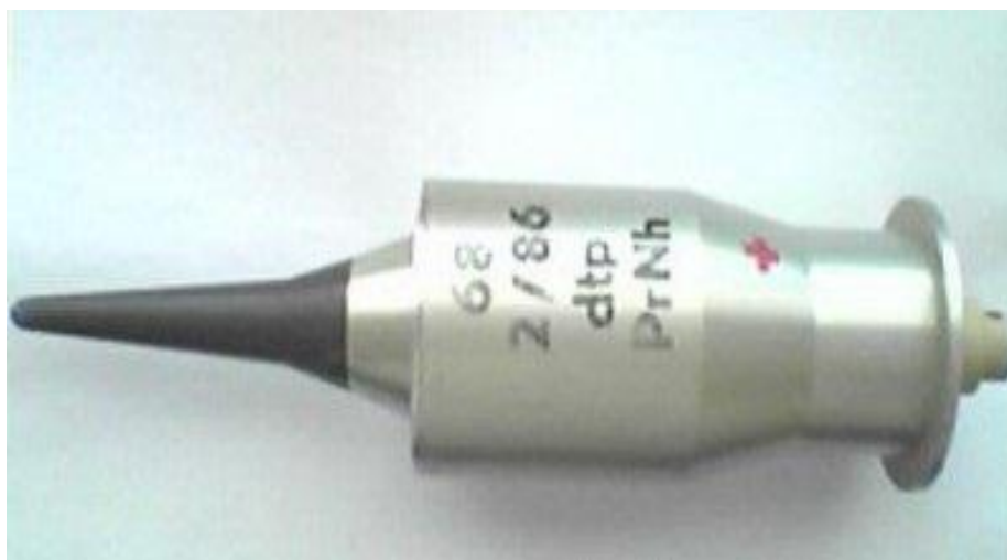
Obr. . 13. RPG 75 s kumulativní hlavicí Nh ur enou pro výcvik
