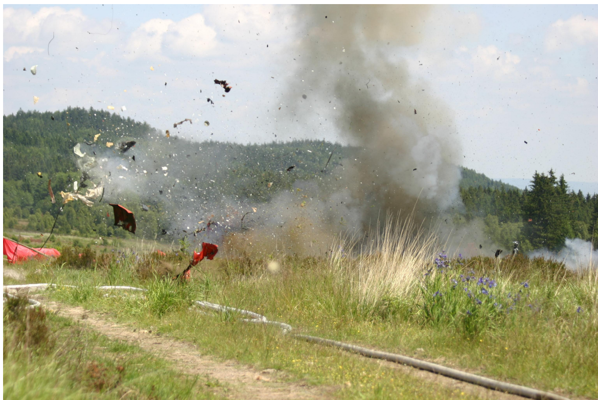
P III. sekundární pr b h výbuchového d je, rozmetání fragment
