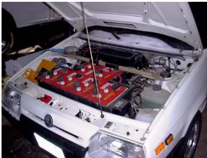
Obrázek 11. Pohled pod kapotu elektromobilu Škody ELTRA 151 L
