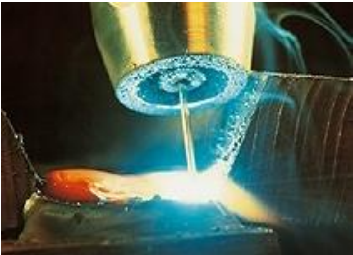
Obr. 2. Princip svařování metodou MIG/MAG - foto
