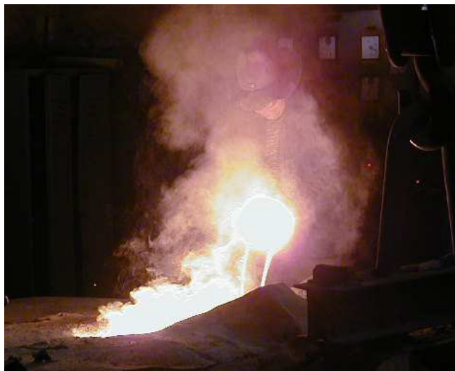
Obr.24. Stáhnutí strusky z pece
