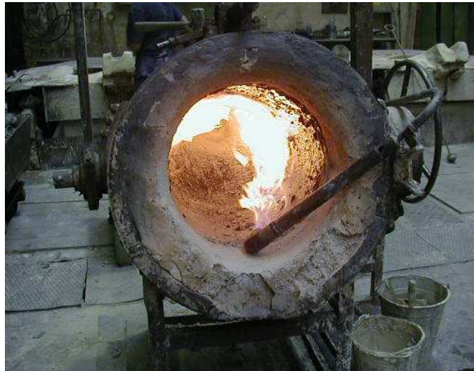
Obr.20. Vypalování licí pánve
