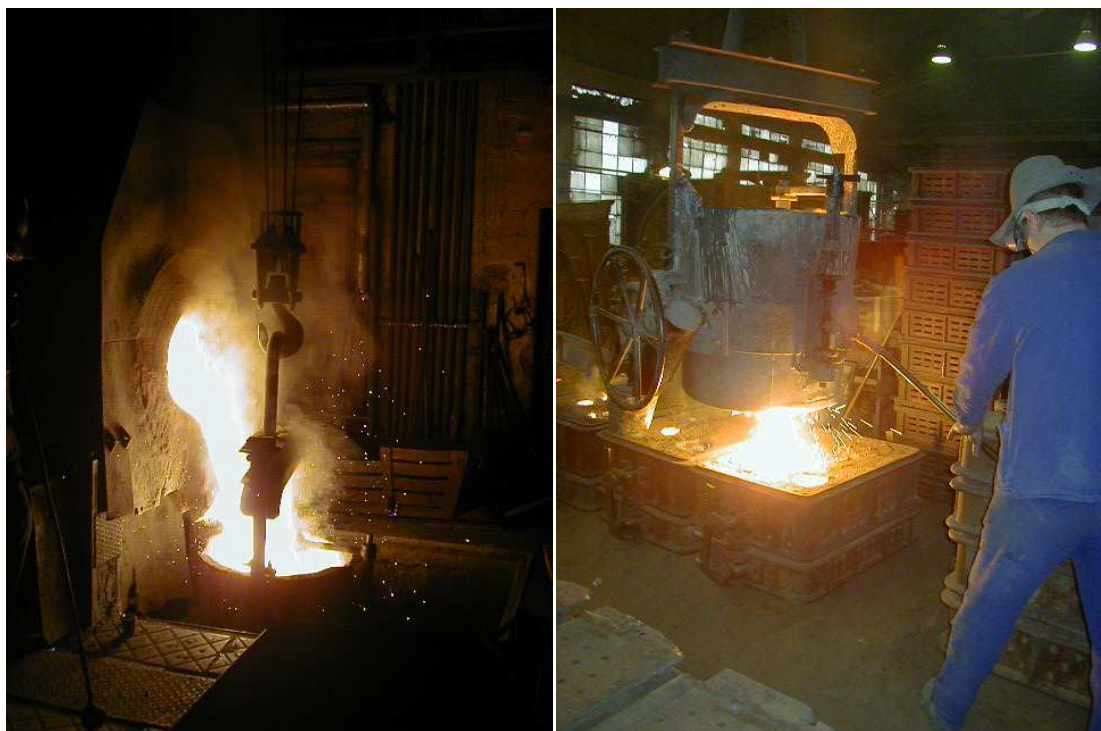
Obr.25. Přelévání taveniny do licí pánve (levý) a odlévání (pravý)
