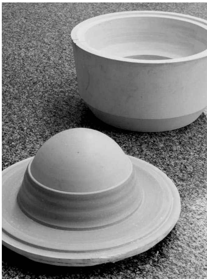
Obr. 23. Rozmnožovací zařízení pro výrobu formy
