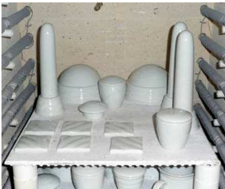
Obr. 27. Výpal glazovaných výrobků
