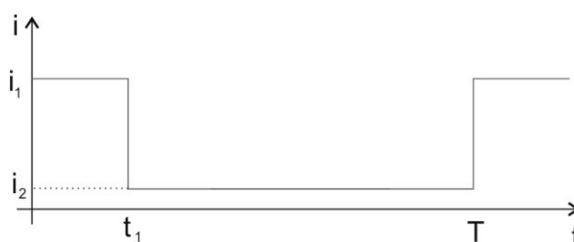
Obr. 9-1 Příklad průběhu proudu odebíraného snímačem AD7415
