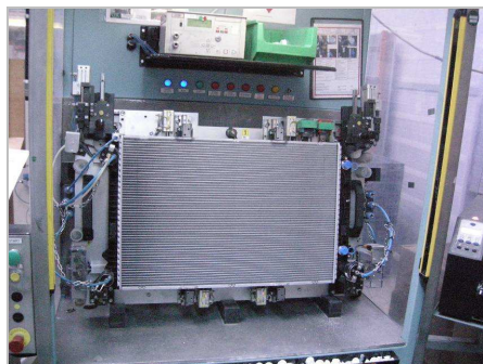
Obr. 20. Testování chladiče [vlastní zpracování]
