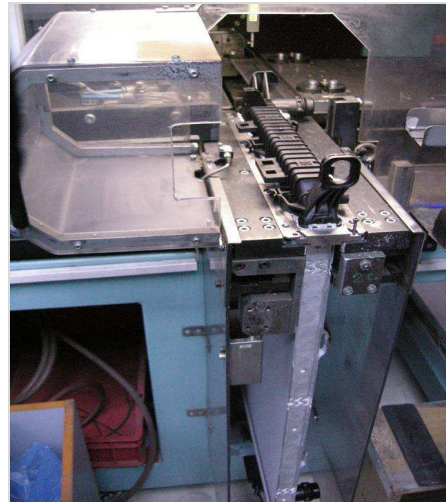
Obr. 18. Lemování komory [vlastní zpracování]
