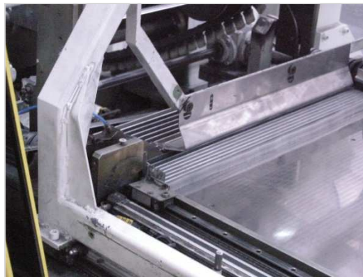
Obr. 14. Vlnovce padají mezi trubky [vlastní zpracování]
