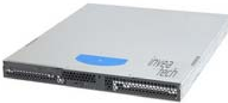
Obr. 41 Standardizovaný model FlowMon sondy
