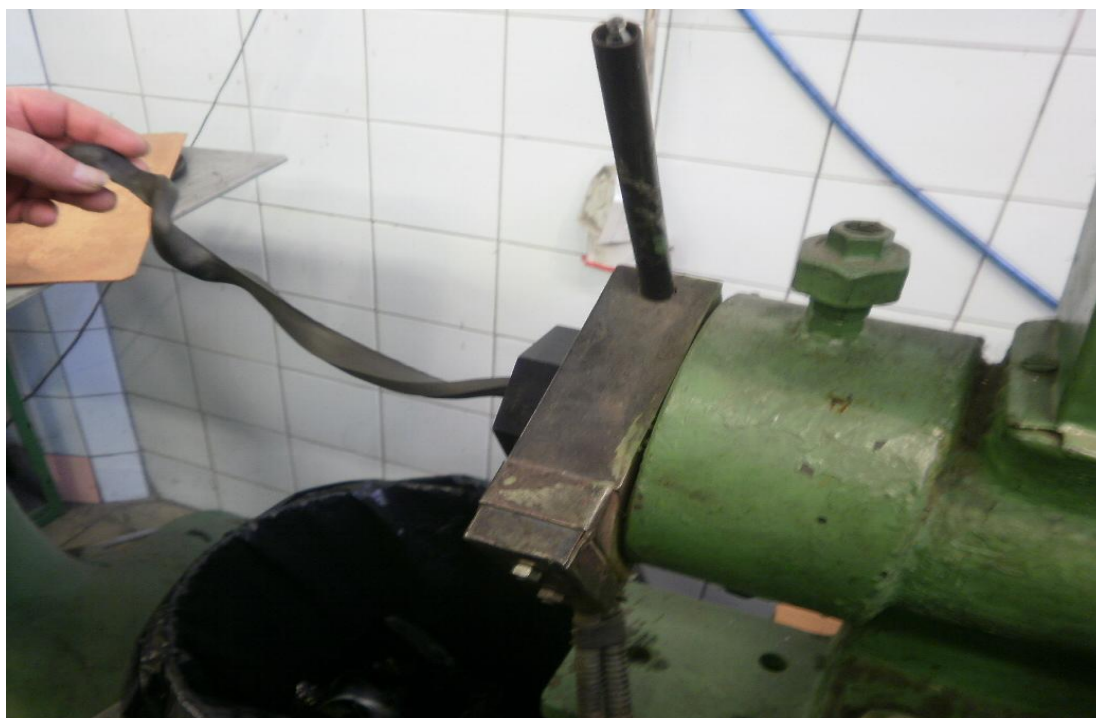
Obrázek 20 Vytlačování porovnávacího profilu na Garveyově hubici
