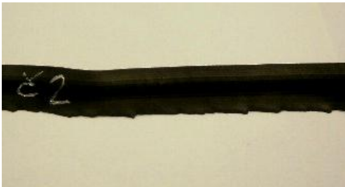
Obrázek 22 Vytlačný profil – č.2 - sazová směs s kaučukem NR SVR 10
