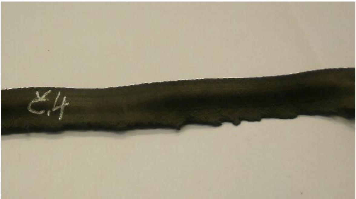
Obrázek 24 Vytlačený profil – č.4 - sazová směs s kaučukem SVR 3 L
