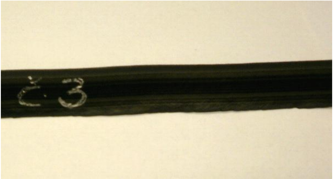
Obrázek 23 Vytlačený profil – č.3 - sazová směs s kaučukem SVR CV61 č.31
