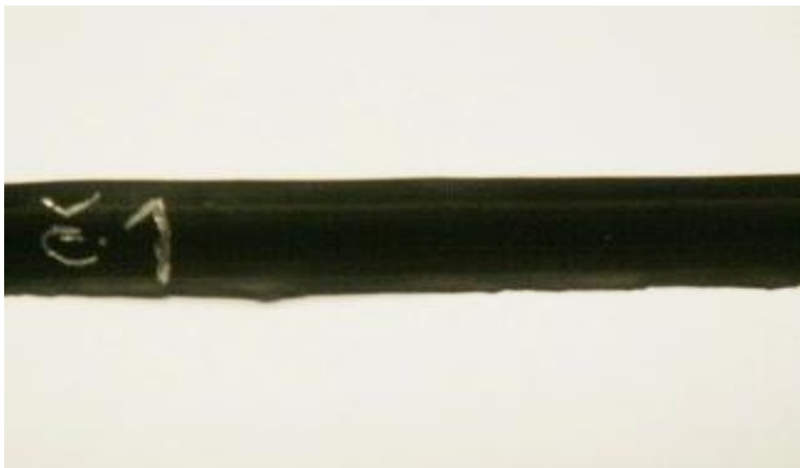
Obrázek 21 Vytlačný profil – č.1 - sazová směs s kaučukem NAT 10
