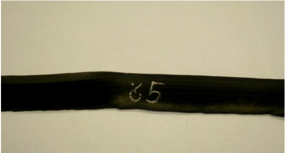
Obrázek 25 Vytlačený profil – č.5 - sazová směs s kaučukem PAKRUB 10, 1024
