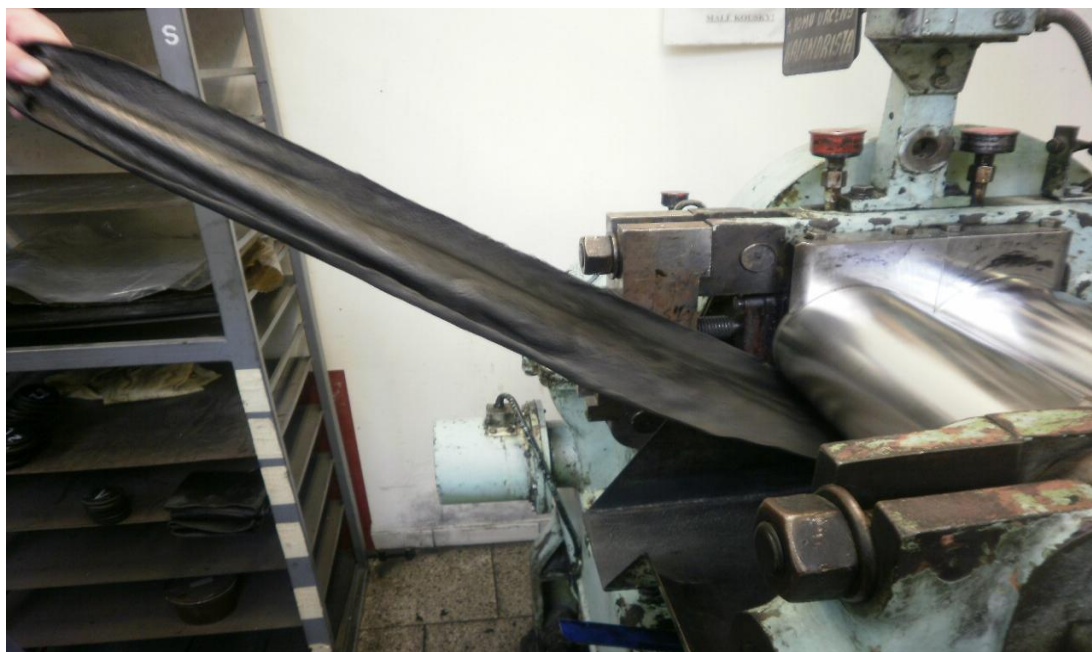
Obrázek 19 Zpracování směsi na dvouválci před vytlačováním
