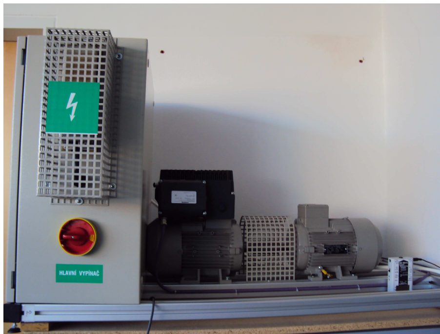
Obr. 42.: Měřené zařízení – sestava asynchronních motorů s integrovaným a externím frekvenčním měničem
