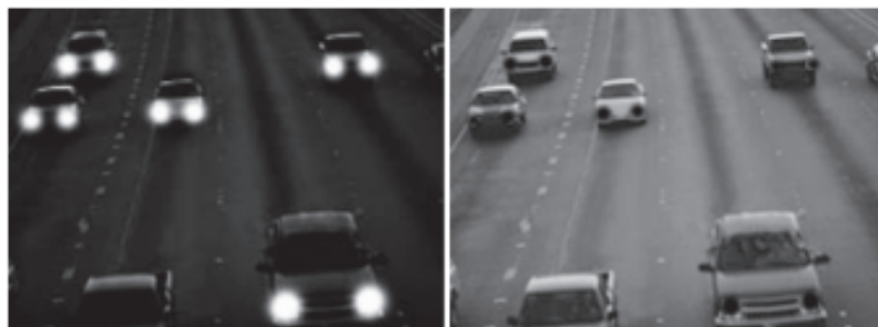
Obr.26.V ľavoobraz bez použitia technológie PWI, vpravo so utotechnológiou
