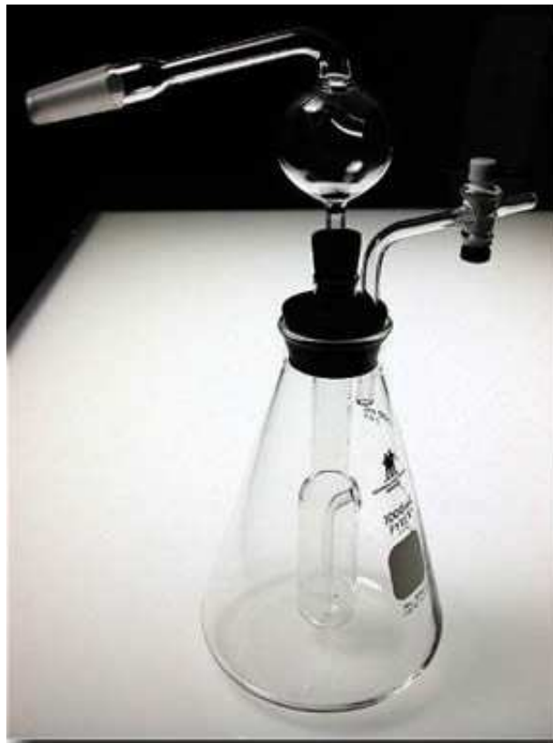
Obrázek 30 – Modifikovaná Hortvet-Sellier destilační aparatura [88]
