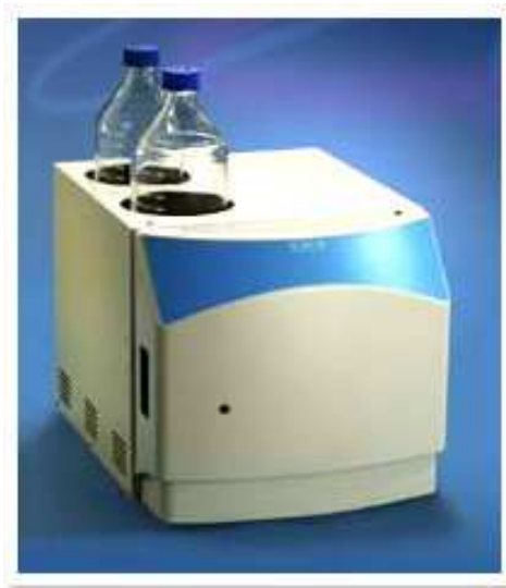
Obr. 2 Gelový permeační chromatograf, výrobce Polymer Laboratories [43].
