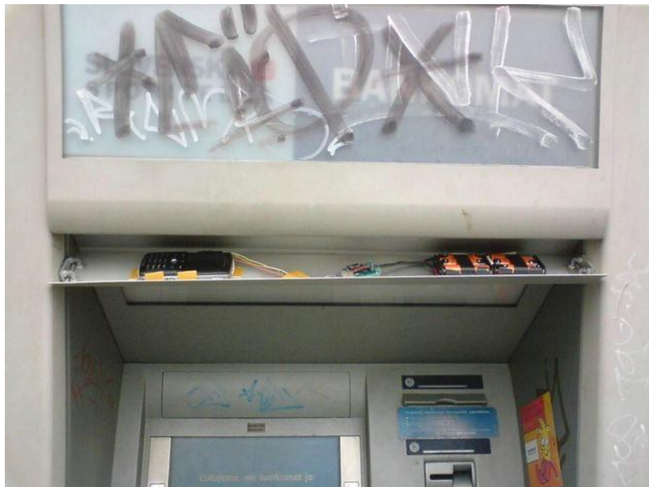
Obrázek 5 – kamera v nástavci snímá zadávání PINu [zdroj: www.ics.muni.cz ] 15
